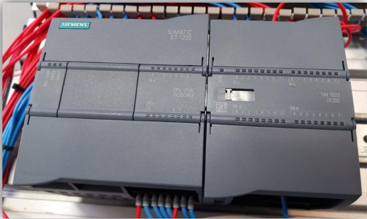
Figura 65 - Imagem fotográfica de PLC CPU S7-1212C AC/DC/RLY com extensão DI/DO SM1223DC/DC
