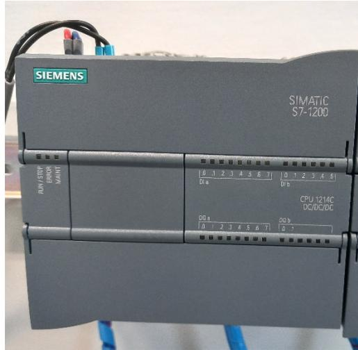
Figura 4 – autómato Siemens – modelo SIMATIC S7-1200
