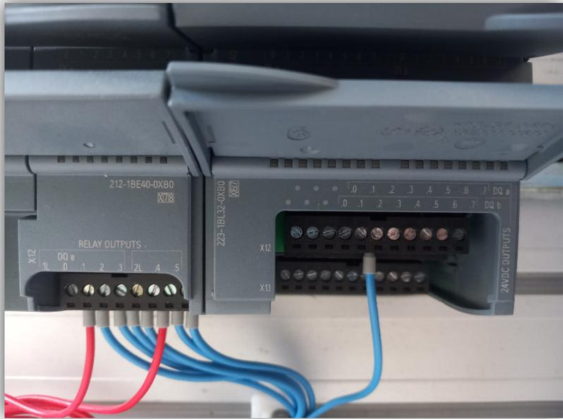
Figura 69 - Imagem da eletrificação do PLC S7-1200 e da extensão DI/DO - Saídas
