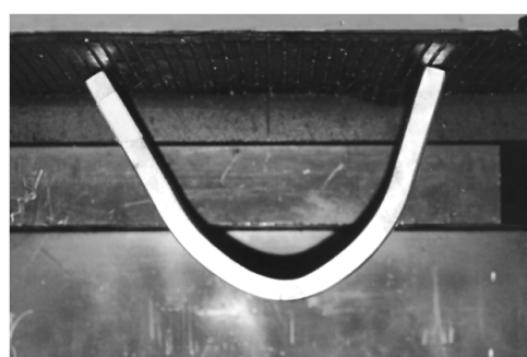
Fig. 29 - Provete após o ensaio de dobragem
